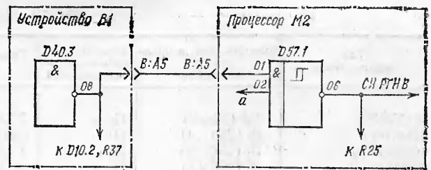
Рис. 3. Принципиальная схема организации совмещенного ввода для микроЭВМ с динамической памятью
